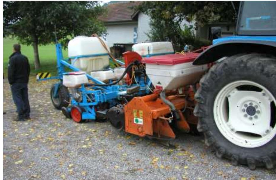
Die Streifenfrässaat von Mais konnte sich nach einer intensiven Entwicklungs- und Erprobungsphase nach 1985 nicht etablieren, da die Flächenleistung zu gering und die Bodenanpassung ungenügend waren. Zudem traten Probleme mit Frässohlen auf und es musste oft länger auf trockene Bodenbedingungen für die Saat gewartet werden.
