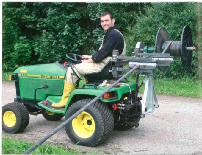
После демонтажа системы капельного полива трубы следует снова поместить на барабан. Если есть помощник, то на свертывание трубок длиной 500 м понадобится не более десяти минут, а 13300 метров трубок, проложенных на площади один гектар поверх гребней, потребуют десять чел.-ч.
