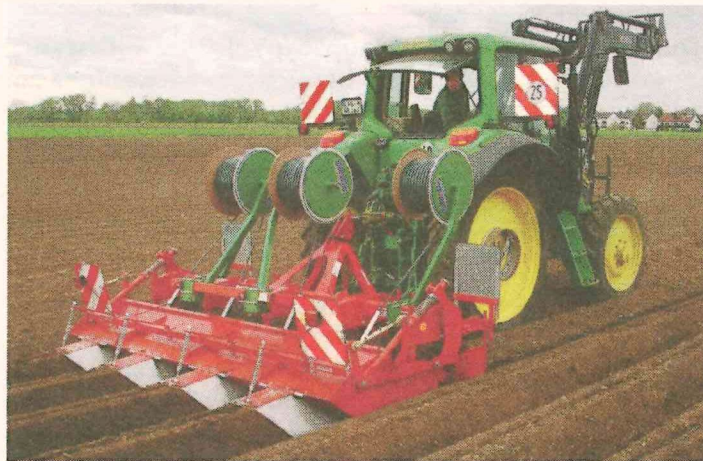
Die hier im Dammkronenverfahren verlegten Schläuche befeuchten die Kartoffeldämme von der Krone her aus.
