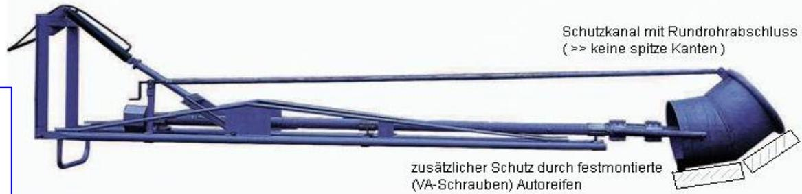
Da in einer gefüllten Güllegrube der Boden nicht einsehbar ist, empfehlen wir das **Anbringen von Autoreifen an dem Rührkanal**, um eine Beschädigung der Folie zu verhindern. Entsprechende Bohrungen sind dafür vorgesehen.
