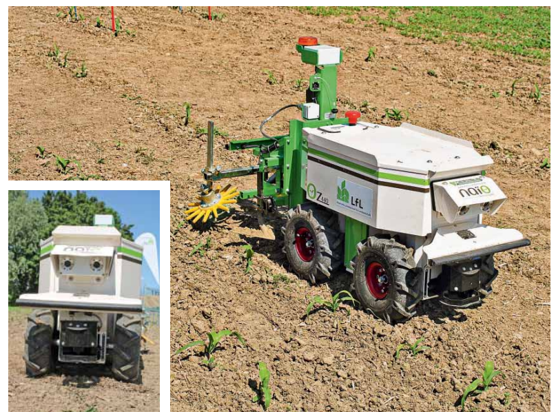
Der Mini-Roboter Naio Oz 440 hat vorne „drei Augen“: Neben den beiden Kameras hat er auch noch ein Lasersystem.
