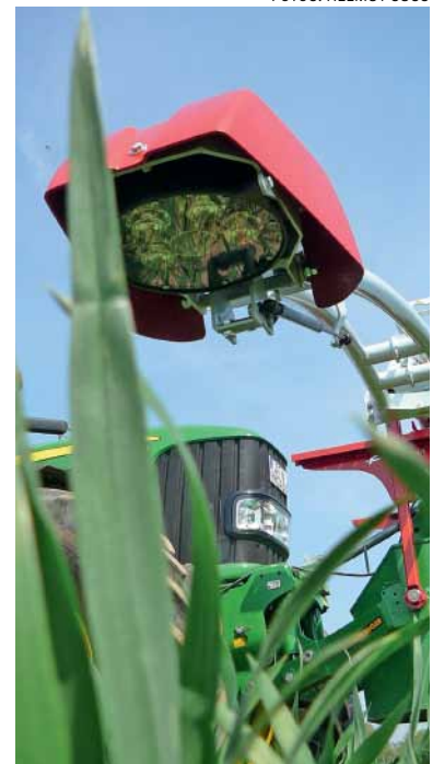
Die Isaria-Sensoren messen Biomasse und Chlorophyllgehalt von Pflanzenbeständen, erkennen daraus den Versorgungszustand und ermöglichen die Anpassung der Düngung in Echtzeit.
