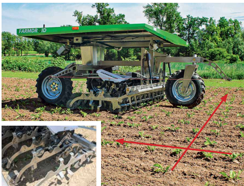
Der Farmdroid-Roboter kann autonom säen und hacken. Die Zuckerrüben stehen exakt in einem Kreuzverband (siehe rote Linien).
