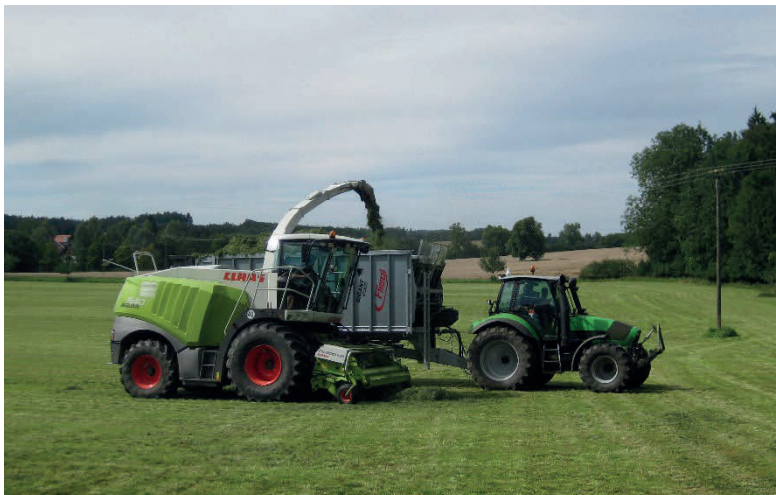
Abbildung 6: Ertragserfassung am selbstfahrenden Feldhäcksler bei der Grünlandernte
