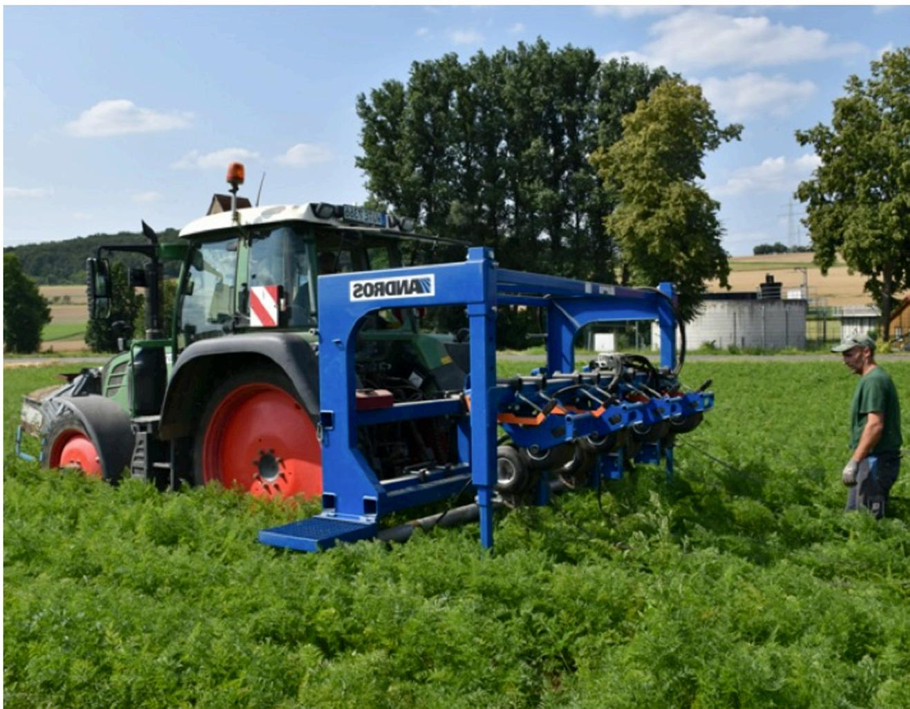
**Bild 4:** Tropfschlauchentnahme bei Möhren mit Technik von Andros Engineering, Quelle: S. Schwab
