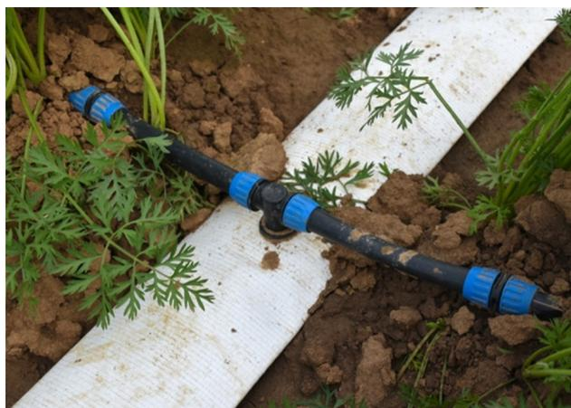
**Bild 3:** Vorgefertigte stabile Verbindung an der Querleitung, bestehend aus T-Verbinder und ca. 15 cm langen dickwandigen Schlauchmaterials, Quelle: S. Schwab
