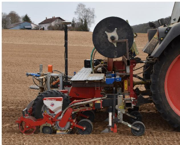
**Bild 2:** Gemüsesämaschine mit Verlegeeinheit für Tropfschläuche aus Eigenbau, Quelle: S. Schwab
