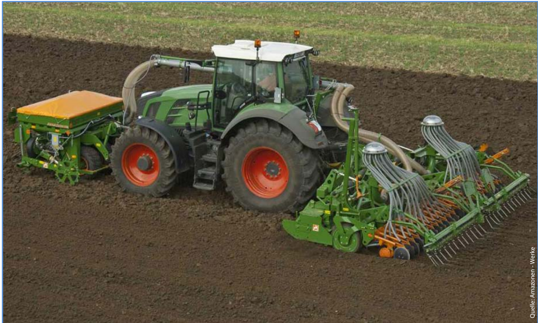
Kreiseleggen – Kombination mit Fronttankdrillmaschine von Amazone
