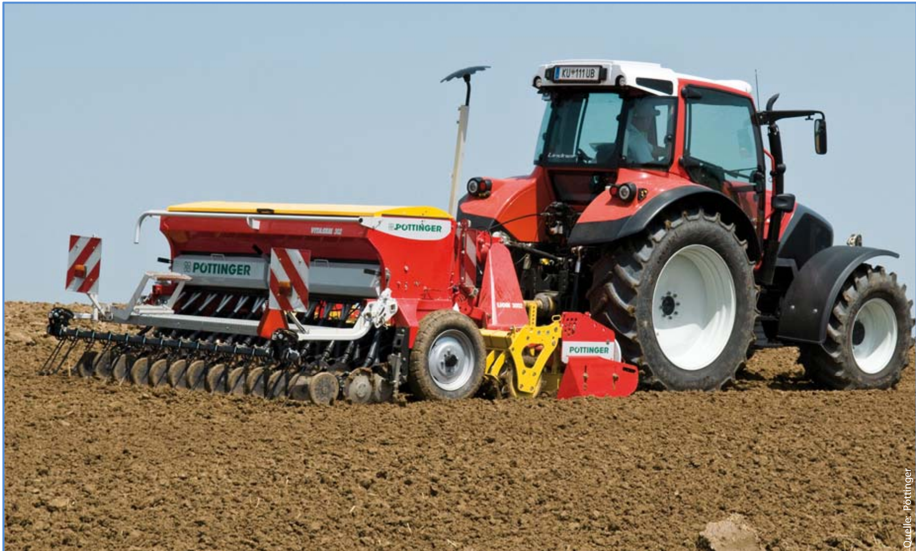
Kreiseleggen – Drillkombination von Pöttinger
