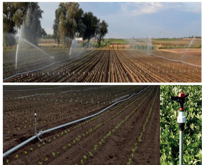
**Bild 3 a,b:** Versuchsaufbau im Praxisbetrieb (Stangensellerie) mit je über 100 Regenmesser zur Erfassung der Wasserverteilgenauigkeit (oben: praxisübliche und unten optimierte Bewässerung mit Druckregulierer unter Kreisregnern), Quelle: A. Dümig
