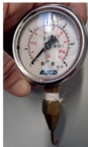
**Bild 4:** Manometer zur Messung des Wasserdrucks bei Kreisregnern, Quelle: A. Dümig
