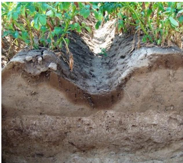
**Bild 1:** Lediglich oberflächennahe Durchfeuchtungswirkung bei ausgetrocknetem, leicht tonigem Sandboden (nFK = 10 Vol.-%) in Folge von 10 mm natürlichem Niederschlag; Dunkelfärbung des Bodens kennzeichnend für Eindringtiefe des Niederschlags
