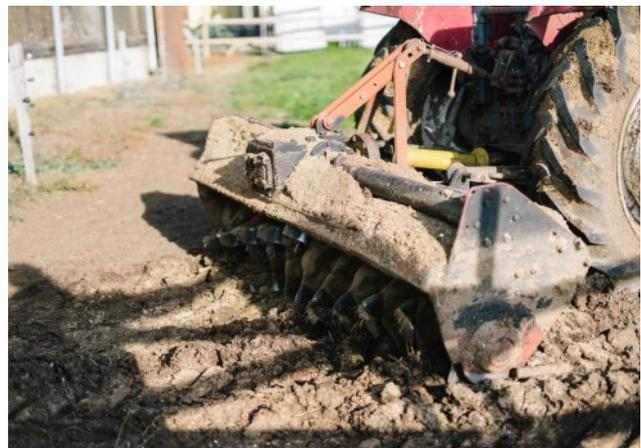
**Bild 9:** Zur Pflege der Kompostmatratze kommen entweder Grubber oder Ackerfräse zum Einsatz.
