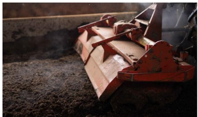
Bild 31: Beim Fräsen entweicht Dampf - ein Zeichen für die hohe Prozesstemperatur in den unteren Kompostschichten.
