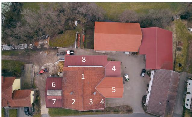
**Bild 2:** Luftaufnahme Betrieb A, 1) Milchvieh Fressbereich, 2) Trockensteher und Abkalbebereich, 3) Kälber, 4) Melkstand und Milchtank, 5) Futtertisch, 6) + 7) Jungvieh, 8) Liegehalle Milchvieh
