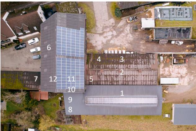
**Bild 47:** Luftaufnahme Betrieb E, 1) Liegehalle, 2) Futtertisch, 3) Jungviehbereich, 4) Kälberbereich, 5) ehemalige Milchammer, 6) Scheune, 7) neuer Milchtankraum, 8) Technikraum, 9) Büro, 10) AMS, 11) Kurzzeitselektion, 12) Abkalbebox
