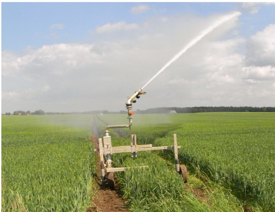
**Bild 1:** Regnerwagen einer mobilen Beregnungsmaschine mit Starkregner (Quelle: LWK Niedersachsen)
